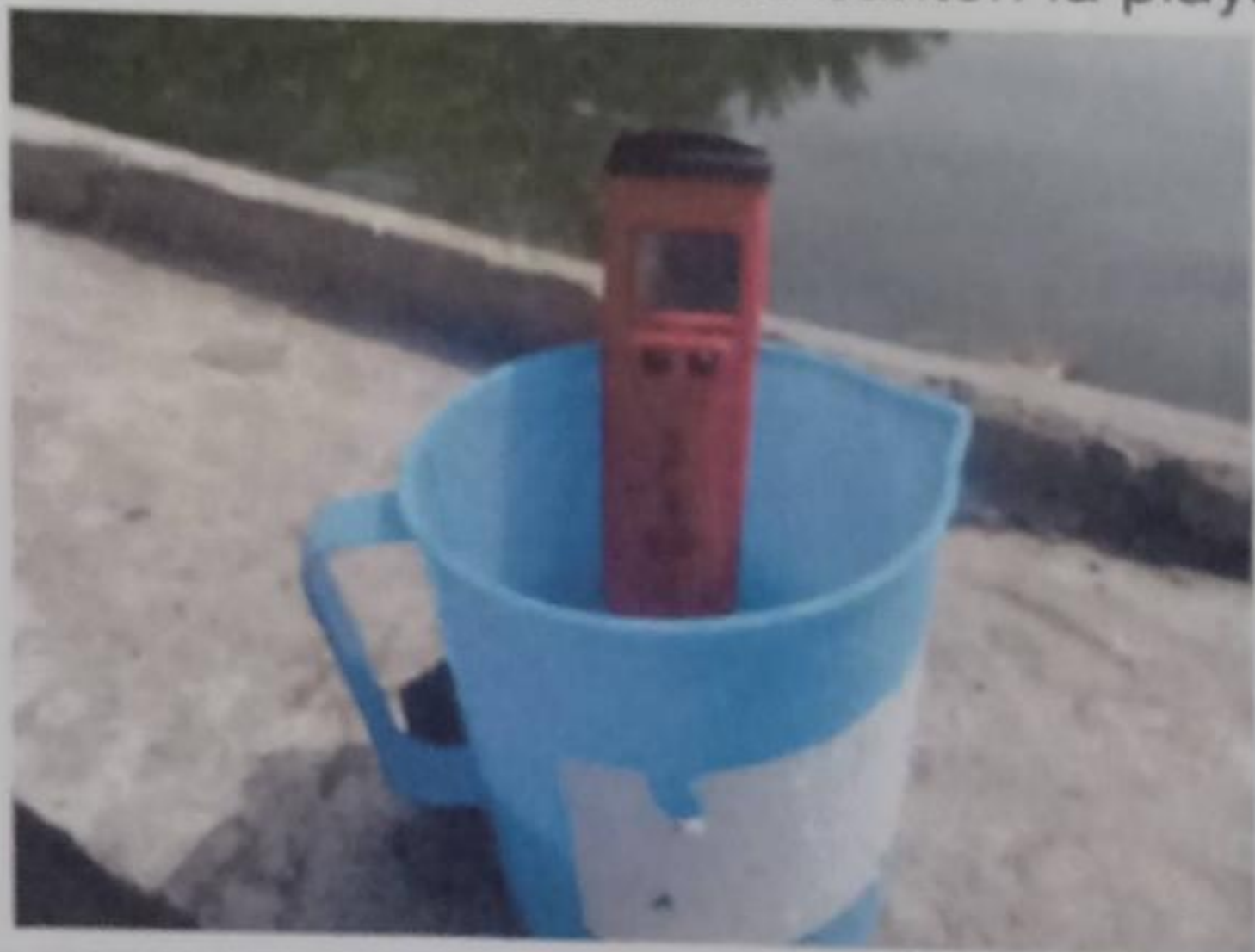
Medición de temperatura y pH de aguas residuales, sistema de tratamiento cantón la Playa
