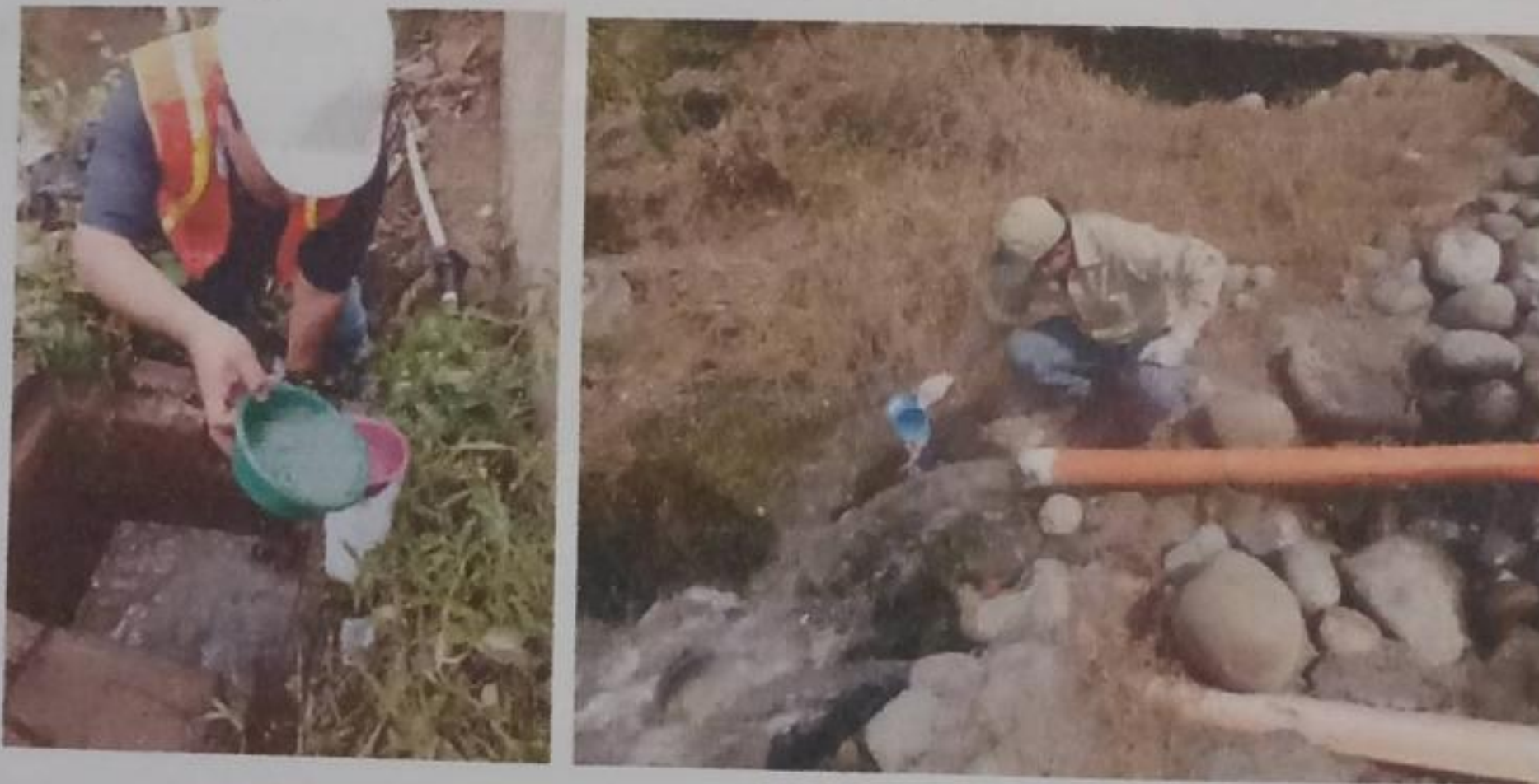
Toma de Muestras de aguas residuales para caracterizar
